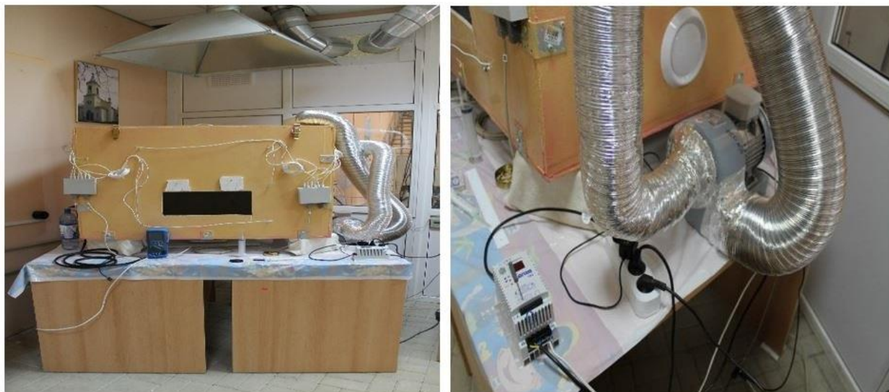
Рисунок 6 – Модель помещения с системой дымоудаления
