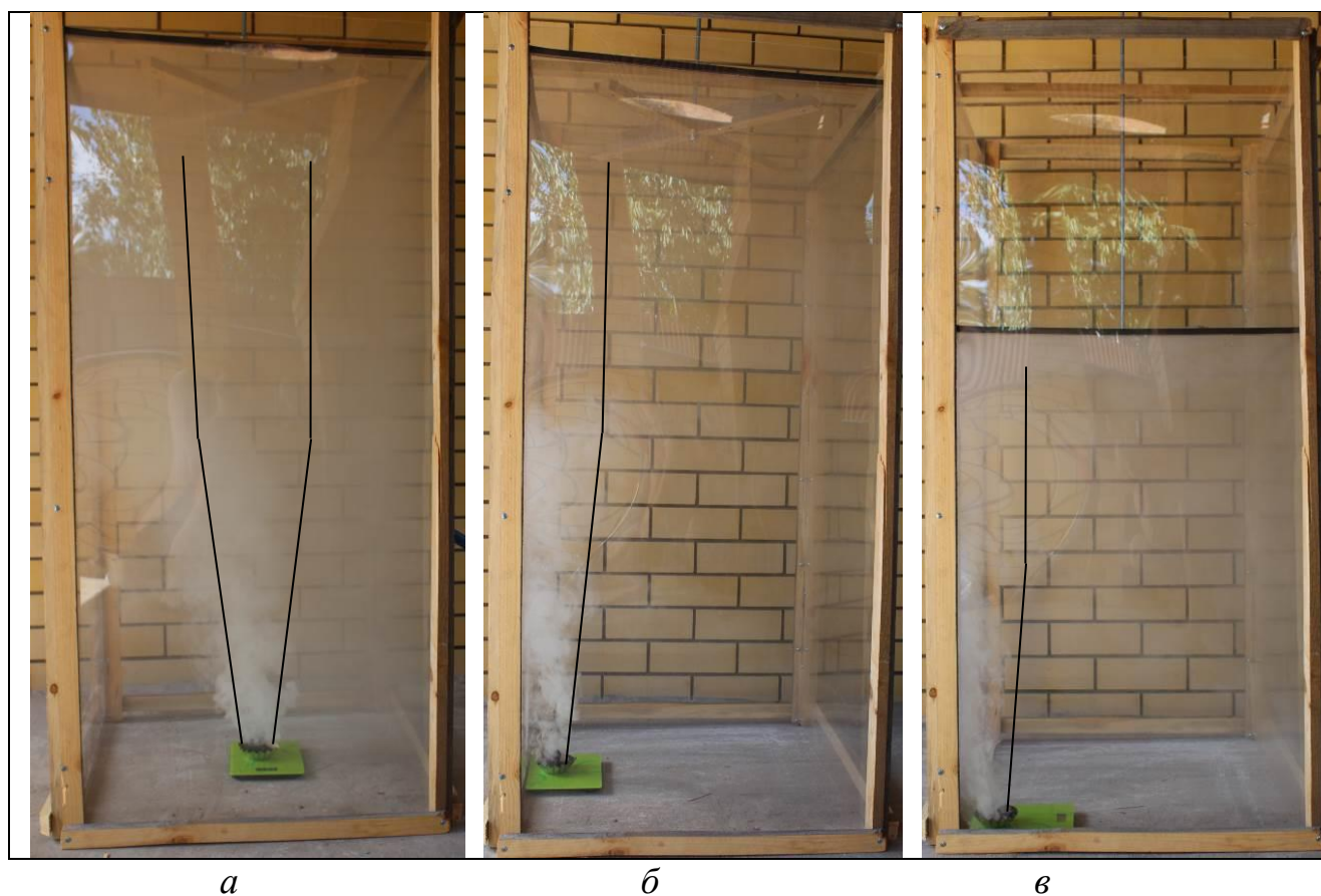
Рисунок 2 – Особенности течения в экспериментальном объеме на начальной стадии пожара: а, б – h = 1,5 м; в – h = 1,0 м
